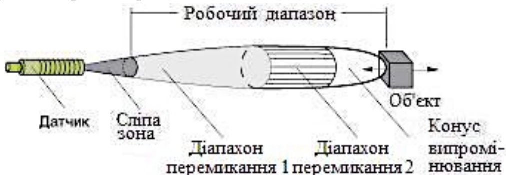
Рис. 4.3. Схема дифузійного режиму роботи ультразвукового датчика
