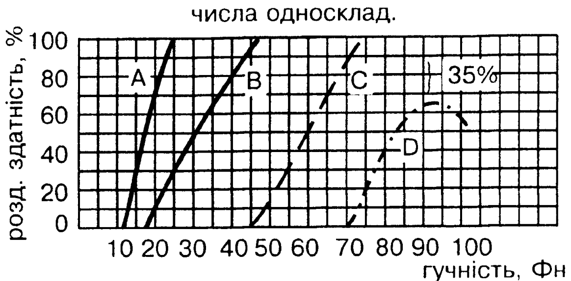
Рис. 6.6. Залежність роздільної здатності від гучності: чисельної (А); словної (В); при передаточній ваді (С); при нерцепційній ваді (D)
