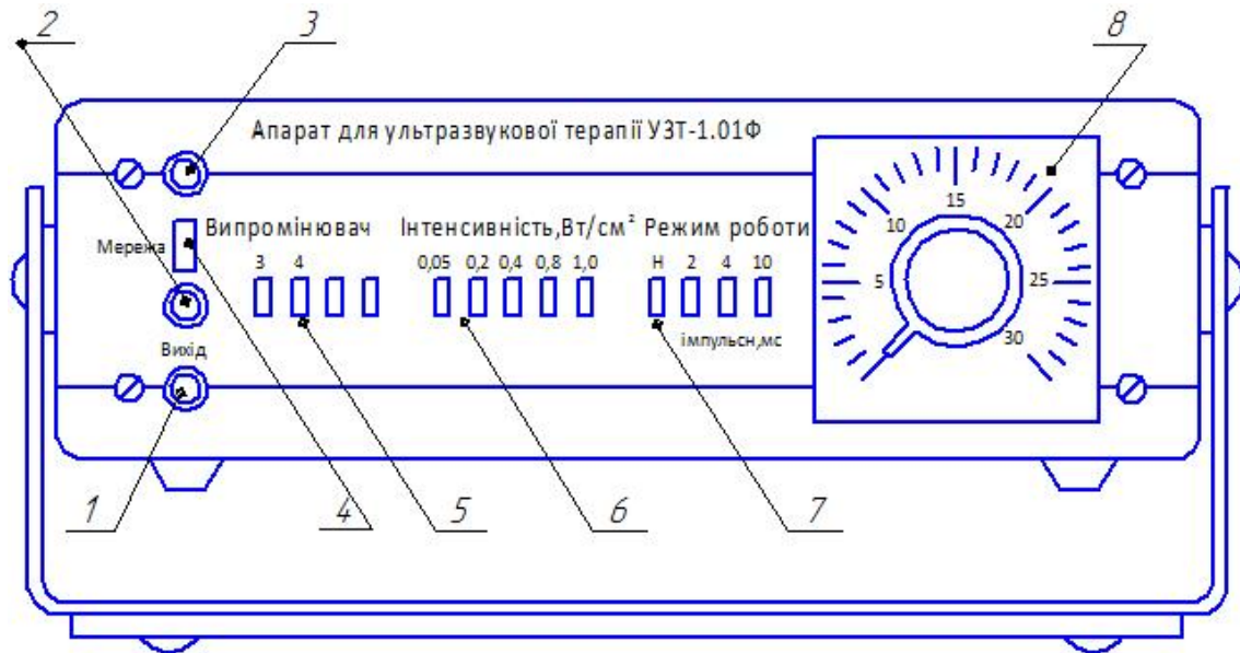
Рис 3.6 Загальний вигляд УЗТ-1.01.Ф: 1- роз'єм «ВИХІД» для підключення кабелю випромінювача; 2- світловий індикатор вихідної напруги апарату; 3- світловий індикатор «МЕРЕЖА» включення апарату; 4 – кнопка «МЕРЕЖА»; 5- перемикач «випромінювач»; 6- перемикач «інтенсивності, Вт/см 2 »; 7 - перемикач «РЕЖИМ РОБОТИ»; 8 - процедурний годинник, за допомогою якого відбувається вмикання апарату в мережу.
