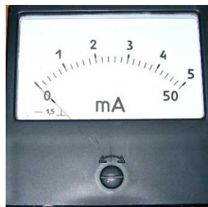
Рисунок 3.11 Міліамперметр М42300 0-5/50mA
