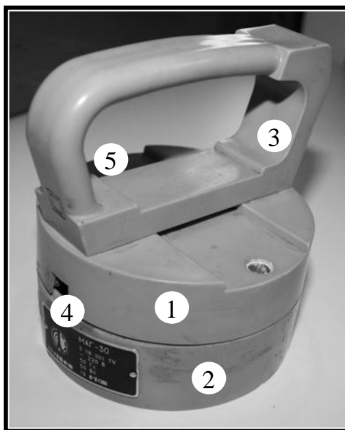
Рисунок 2.4 Зовнішній вигляд апарату «Маг-30»: 1 – кришка; 2 – основа; 3 – ручка; 4 – вивід до мережі; 5 – індикатор
