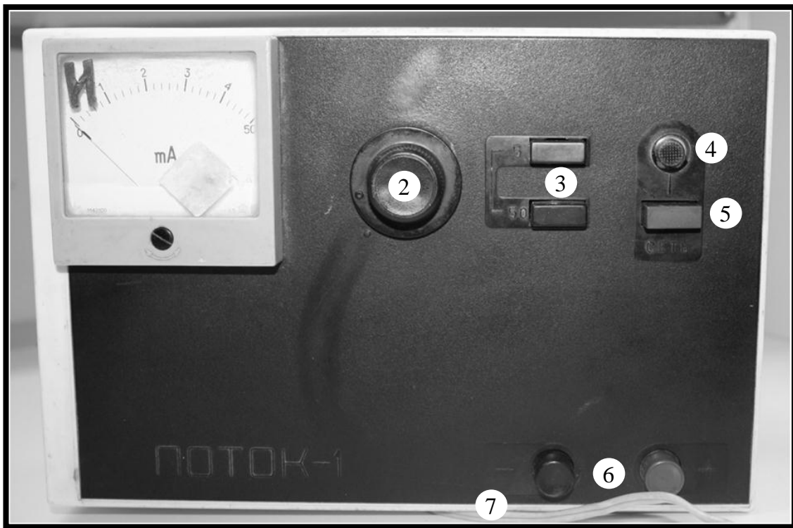
Рисунок 1.2 Зовнішній вигляд апарату для гальванізації та електрофорезу «Поток-1»: 1 – міліамперметр; 2 – ручка регулятора струму; 3 – кнопки ввімкнення діапазонів 5 та 50 Гц; 4 – індикатор; 5 – кнопка ввімкнення апарату; 6 – вихідні клеми «+» та «-»
