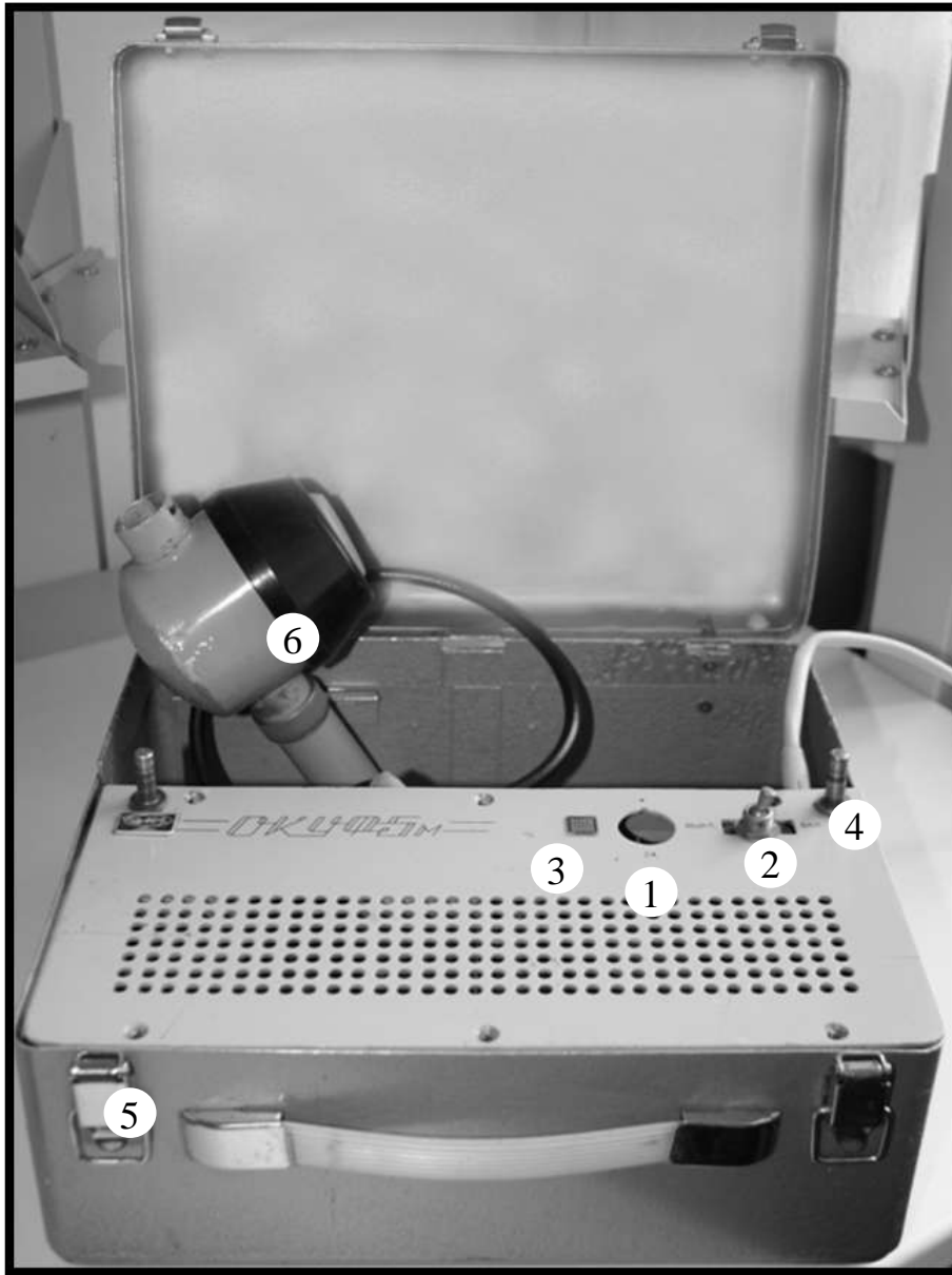
Рисунок 4.1 Зовнішній вигляд апарату для ультрафіолетової терапії «ОКУФ-5М»: 1 – перемикач мережі; 2 – вимикач напруги; 3 – сигнальна лампа; 4 – штирі; 5 – корпус; 6 – опромінювач
