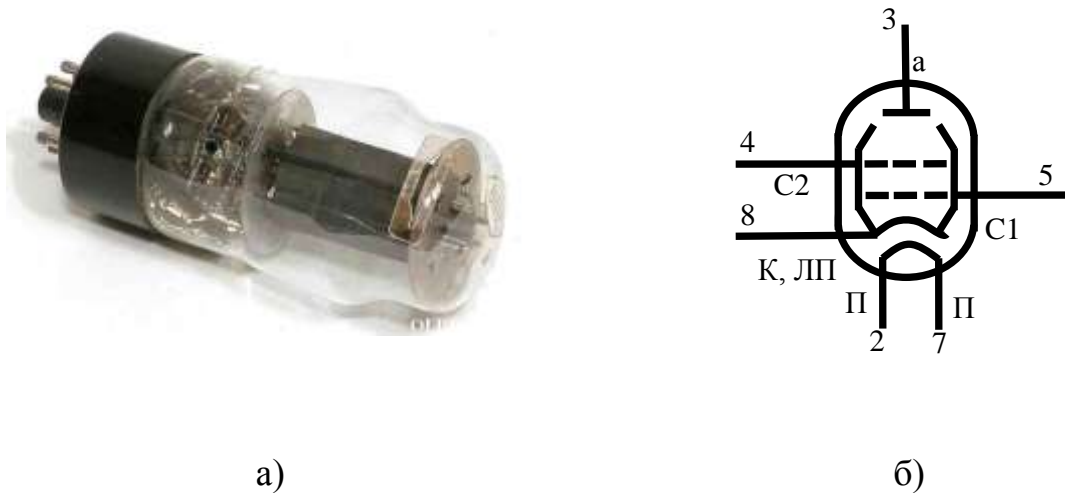
Рисунок 4.5 Радіолампа 6ПЗС: а) зовнішній вигляд, б) схематичне зображення; а – анод; С1 - сітка перша; С2 - сітка друга; ЛП - променеутворюючі пластини; К – катод; П - підігрівач катода
