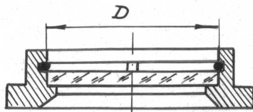
Рис. 8.8. Схема кріплення лінз розрізним кільцем
