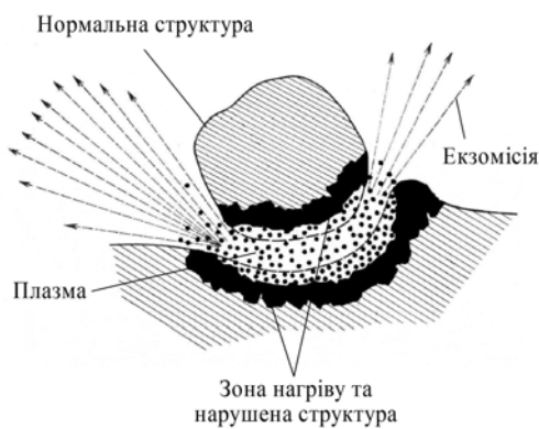
Рис. 3.10. Схема утворення «магма-плазми» при механічному активуванні матеріалу
