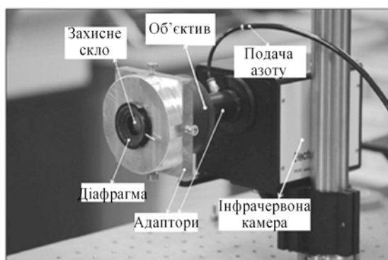
Рис. 2.7. Експериментальна система для проведення температурних досліджень
